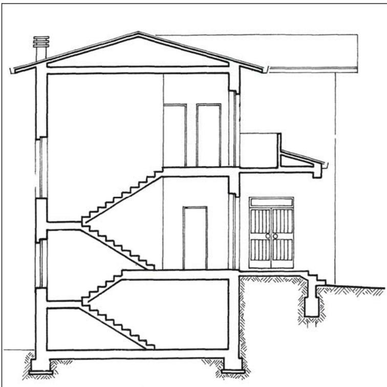
Figura 9 Municipio. Sezione del vano scale (come da progetto del 1979).
